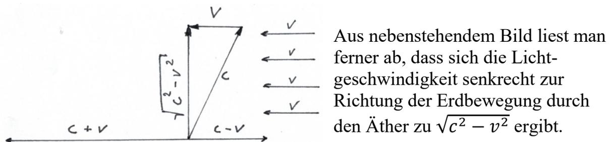
Diese Unterschiede in der Lichtgeschwindigkeit wollte Michelson zur Bestimmung der Erdbewegung folgendermaßen ausnutzen: Lichtsignale durchlaufen zwei aufeinander senkrecht stehende Arme eines „Michelson Interferometers“ und werden dort von Spiegeln wieder zum Ausgangspunkt zurückreflektiert.
