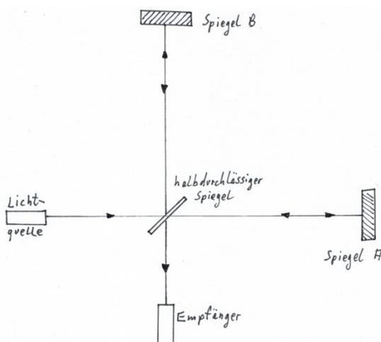
Das Licht aus der Quelle wird durch eine planparallele Platte in zwei Teilstrahlen aufgespalten, welche zwei aufeinander senkrecht stehende Arme jeweils hin und her laufen. Anschließend wird im Empfänger die Interferenz der beiden Teilstrahlen miteinander beobachtet.
