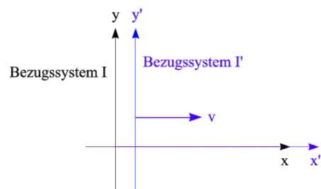
Das gestrichene Bezugssystem bewegt sich mit der Geschwindigkeit  $v$  in Richtung der positiven  $x$ -Achse. Die beiden parallelen  $z$ - bzw.  $z'$ -Achsen sind nicht eingezeichnet.
